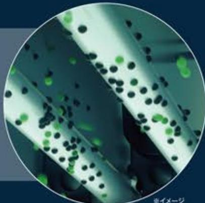
TPAフィルターは汚染物質（ウイルス・細菌・カビ・花粉など）に電圧をかけて吸着させるためのフィルターです
